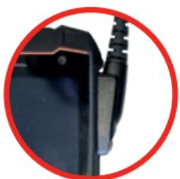
13 PIN-stik, der er tilsluttet ISM-interface - ved hjælp af eksemplet på **IS530.1**.
