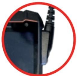
13 konektorů PIN připojených k rozhraní ISM - na příkladu IS530.1.
