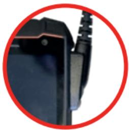
ISMインターフェースに接続された13PINコネクタ-。IS530.1を例に挙げて説明します。
