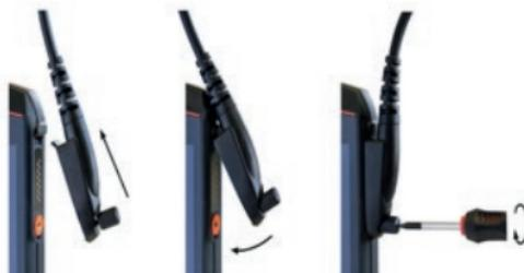
» Conecte o plugue do acessório aprovado à interface 13-pin ISM, conforme exibido.
