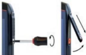
» Lösen Sie die Schraube an der 13-pin ISM-Schnittstellenabdeckung mit dem mitgelieferten Schraubendreher und entfernen Sie die Abdeckung wie abgebildet. Der Schraubendreher ist im Lieferumfang des Zubehörs enthalten.
