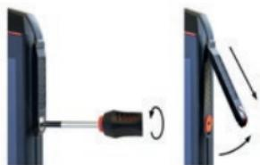
» Löysennä 13-pin ISM-liitännän suojuksen ruuvit toimitukseen sisältyvällä Torx-ruuvitallalla ja poista suojuksien kuvan mukaisesti. Ruuvitallta sisältyy tarvikkeepakaukseen.
