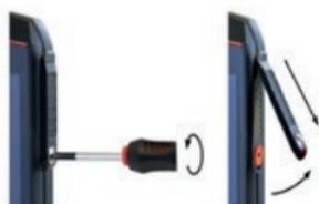
» Solte o parafuso da tampa da interface 13-pin ISM usando a chave de fenda fornecida, e remova-a conforme exibido. A chave de fenda está incluída no pacote acessório.
