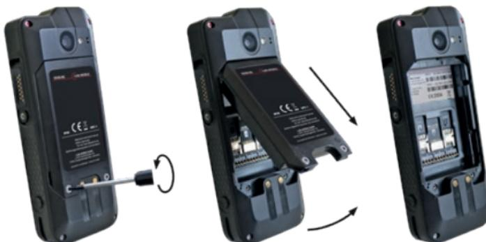
» Solte os parafusos da bateria utilizando a chave Torx fornecida.
