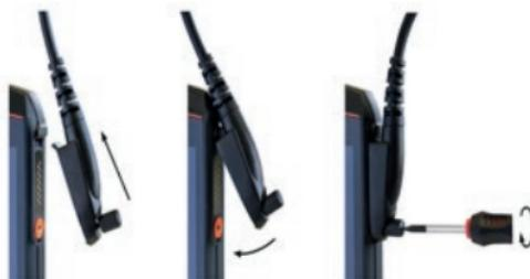
» Conecte el enchufe del accesorio homologado a la interfaz 13-pin ISM del dispositivo tal y como se muestra.
