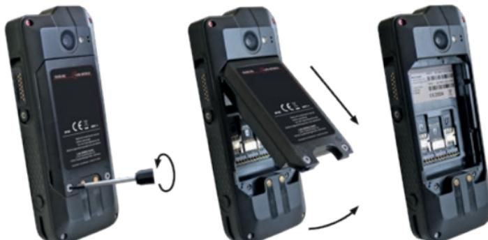
» Allentare le viti sulla batteria con il cacciavite Torx in dotazione.
