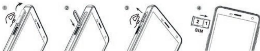
» Insérez la carte SIM dans le slot. L'appareil possède un slot pour deux cartes SIM ou pour une carte SIM en combinaison avec une carte microSD.
