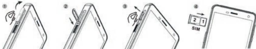
» Insérez la carte microSD dans le slot. L'appareil possède un slot pour une carte SIM en combinaison avec une carte microSD jusqu'à 128 Go, voir également section « Insertion/retrait de la carte SIM ».
