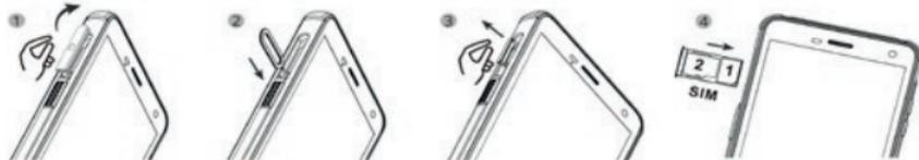
» Stoppa i microSD-kortet i kortfacket. Apparaten har ett kortfack för ett SIM-kort kombinerat med ett microSD-kort på upp till 128 GB, se även avsnitt "Sätta i/ta ur SIM-kort".
