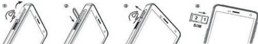
» Stoppa i SIM-kortet i kortfacket. Apparaten har ett kortfack för två SIM-kort eller ett SIM-kort kombinerat med ett microSD-kort.
