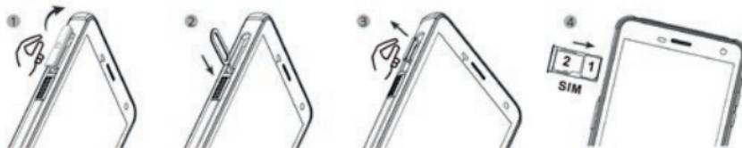
» Zasuňte kartu microSD do zásuvné pozice. Zařízení disponuje zásuvnou pozicí pro jednu kartu SIM v kombinaci s kartou microSD do velikosti 128 GB, viz také část „Vložte/vyjměte SIM kartu“.
