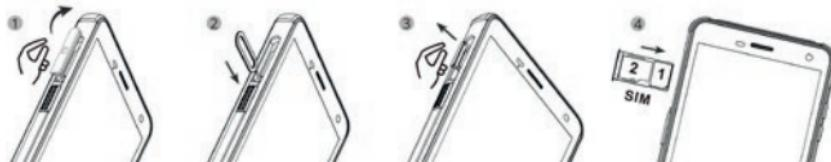
» Læg SIM-kortet i stikpladsen. Enheden har en stikplads til to SIM-kort eller til et SIM-kort i kombination med et mikroSD-kort.
