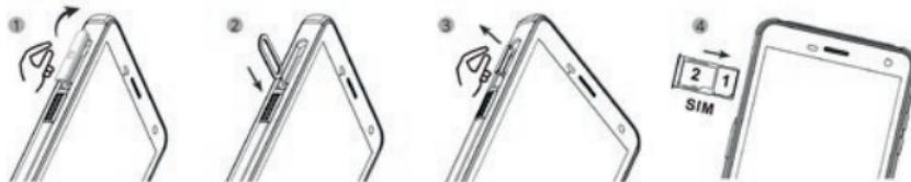
» Introduzca la tarjeta microSD en la ranura. El dispositivo dispone de una ranura para una tarjeta SIM en combinación con una tarjeta microSD de hasta 128 GB, véase también la sección «Insertar/extrair la tarjeta SIM».
