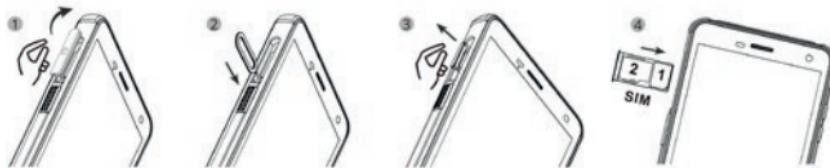
» Legen Sie die microSD-Karte in den Steckplatz. Das Gerät verfügt über einen Steckplatz für eine SIM-Karte in Kombination mit einer microSD-Karte bis 128 GB, siehe auch Abschnitt „SIM-Karte einlegen/Entnehmen“.
