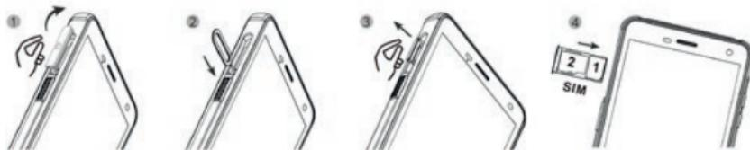
» SIMカードを差込スロットに挿入します。本デバイスにはSIMカード2枚、またはSIMカードとmicroSDカードを一度に挿入できる差込スロットが備わっています。
