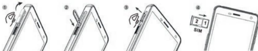
» Do slotu vložte SIM kartu. Slot v zariadení umožňuje použitie dvoch SIM kariet súčasne alebo jednej SIM karty v kombinácii s microSD kartou.
