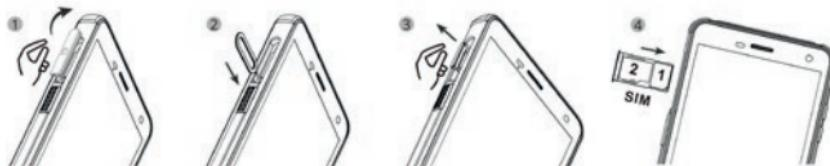
» Læg mikroSD-kortet i stikpladsen. Enheden har en stikplads til et SIM-kort i kombination med et mikroSD-kort op til 128 GB, se også afsnit „Isæt/udtag SIM-kort“.
