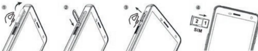
» 差込スロットにmicroSDカードを挿入します。本デバイスにはSIMカードと128 GBを上限とするmicroSDカードを一度に挿入できる差込スロットが備わっています。「SIMカードの挿入/取り出し.」の章も参照してください。
