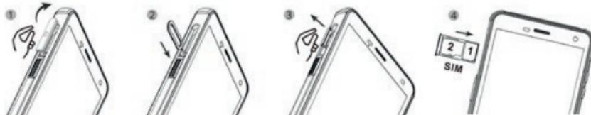
» Zasuňte kartu SIM do zásuvné pozice. Zařízení disponuje zásuvnou pozicí pro dvě karty SIM nebo pro jednu kartu SIM v kombinaci s kartou microSD.
