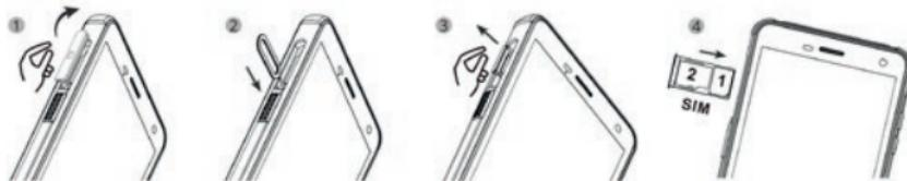
» Вставьте SIM-карту в слот. В устройстве есть слот для двух SIM-карт или для SIM-карты в сочетании с картой microSD.
