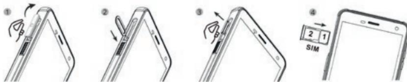
» 将 microSD 卡插入插槽。该设备的其中一个插槽可以插入 SIM 卡或者最大为 128 GB 的 microSD 卡，请另参阅“插入/移除 SIM 卡”部分。
