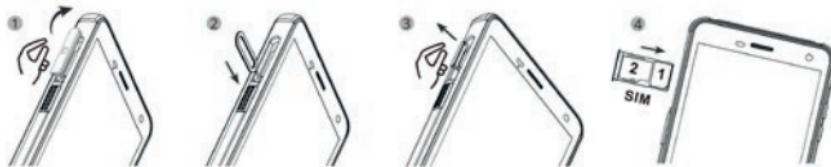
» Вставьте карту microSD в слот. В устройстве есть слот для SIM-карты в сочетании с картой microSD до 128 ГБ, см. также раздел „Установка/снятие SIM-карты“.
