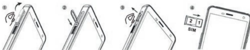
» Włożyć kartę microSD do gniazda. Urządzenie posiada gniazdo na kartę SIM w połączeniu z kartą microSD o pojemności do 128 GB, patrz także punkt „Wkładanie/wyjmowanie karty SIM”.
